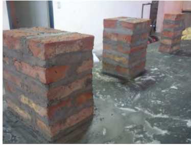
Figura 4: Pilas de Mampostería en Laboratorio
